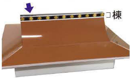
【写真5】飾り瓦使用の推定模型 瓦の使用は棟など限られた箇所であり、屋根根部分は檜皮葺(ひわだぶき)もしくは板葺きであったと考えられる。
